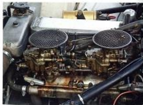
Motorn kommer från Hillman Minx men är här uppskrämd till nästan 80 hästar. Hillman var Rootes-gruppens vanliga personbilsvarumärke medan sportbilarna såldes under namnet Sunbeam.
